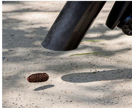
FICHTENZAPFEN: Nur die Geräte von Stihl und Makita saugten einen Fichtenzapfen ein – bei allen anderen fiel er zurück.
