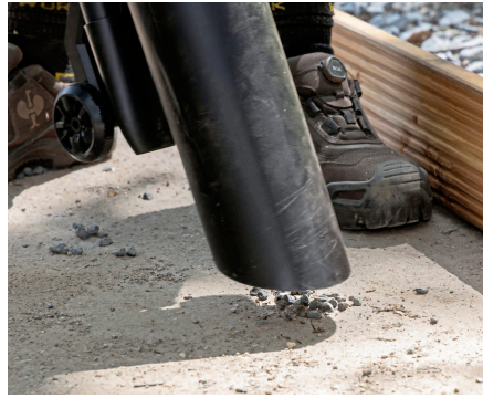
STEINE SAUGEN: Feiner Kies gelangte bei den Geräten zwar in die Luftsäule der Saugrohre, wurde aber nicht eingesaugt.
