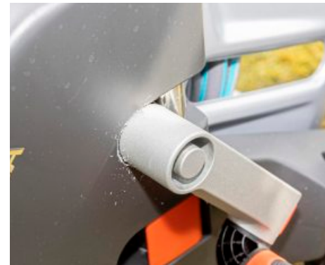
- ABNUTZUNG: Beim Aufrollen kam es bei beiden Gardena-Modellen zu einem Materialabrieb am Gehäuse.
