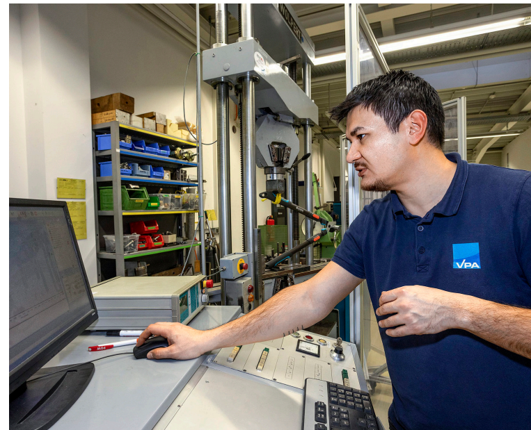
Über den Computer wurde die maximale Prüflast für die Belastbarkeitstests eingegeben.
