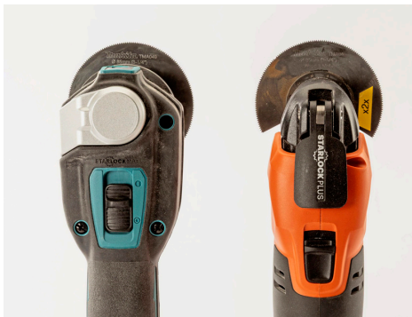
TIEFENBEGRENZUNG: Bei Makita (links) schränkt der große Kopf die Schnitttiefe – im Vergleich zu Fein (rechts) – z. T. stark ein.
