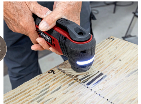
SCHABER: Oszillationsgeräte (hier Einhell) eignen sich auch zum Entfernen weicher Kleberreste unter Teppich oder PVC.
