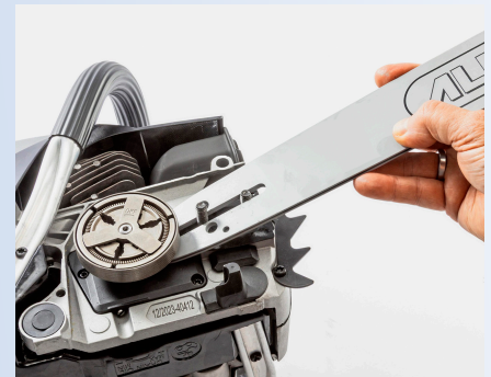
Liegt die Bremsglocke vorn, muss zunächst die Schiene schräg eingelegt ...
