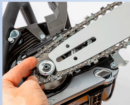
Bei vorgelagertem Ritzel: Schiene und Kette werden gemeinsam montiert.
