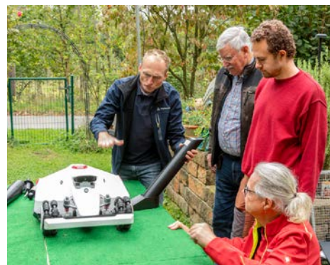
Mit einem Norm-Fuß wird getestet, ob es zu einem Kontakt mit dem Mähwerk kommt.
