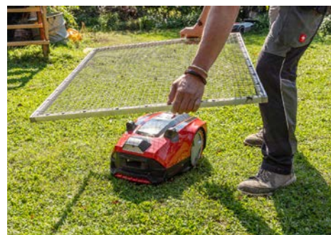
Mit einem Metallgitter haben wir den Satellitenempfang im Mähbetrieb gestört.
