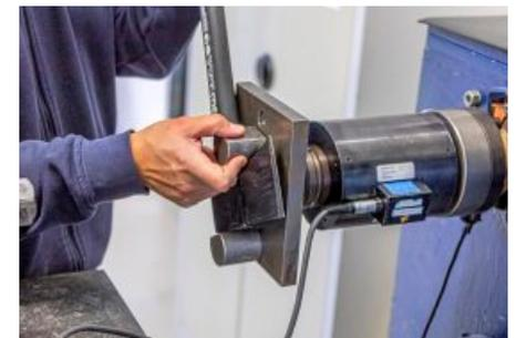
Der Kopf wird in der Drehmoment-Testmaschine fixiert.
