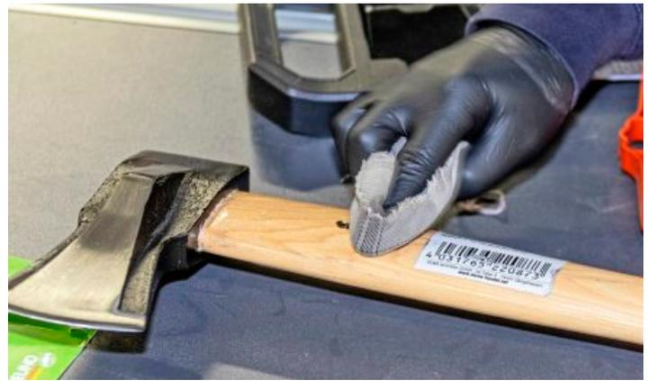
**LÖSEMittel:** Mit dem Wischtest nach Normvorgabe werden aufgedruckte Angaben auf Dauerhaftigkeit geprüft.
