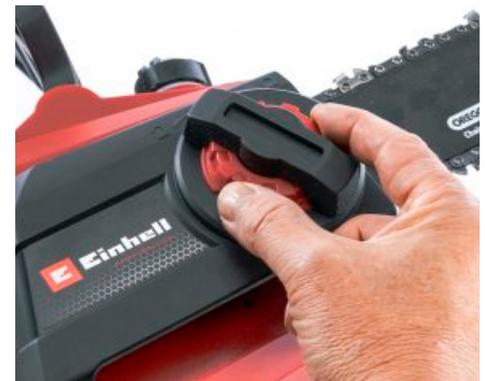
**+ EINFACH:** Eine werkzeuglose Kettenspannung ist inzwischen der Standard.
