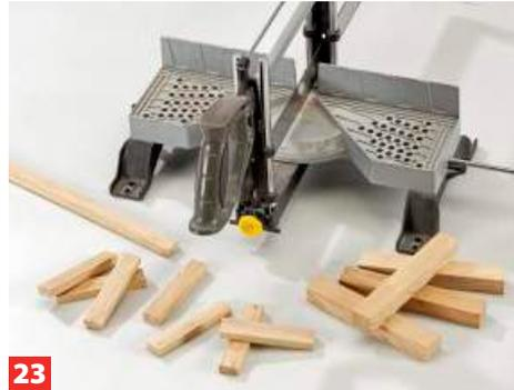
**23** Schneiden Sie die Hölzer für die Seitenlamellen des Nistkastens zu. Die 20-x-25-mm-Leisten dienen als Auflager für ...
