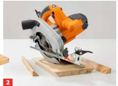
Der Nistkasten besitzt einen quadratischen Grundriss. Die vier Wände auf Gehrung (Außenmaß 180 mm) zuschneiden.
