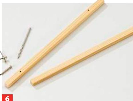
Durchbohren Sie die Leisten mindestens je zweimal für kurze Drahtstifte. Wir haben einen 2-mm-Bohrer verwendet.
