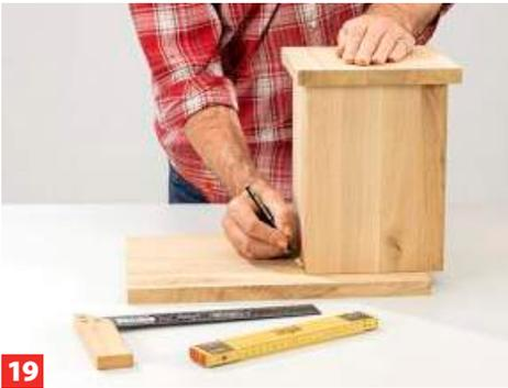
**19** Schneiden Sie das 380 x 260 mm große Futterplatz-Dach zu. Markieren Sie den Ausschnitt für den Nistkasten – er ...
