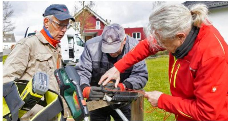
**+ SIMPEL:** Faden durchstecken und dann die Kassette drehen – Trimmfaden nachfüllen (nicht nur) bei Worx.
