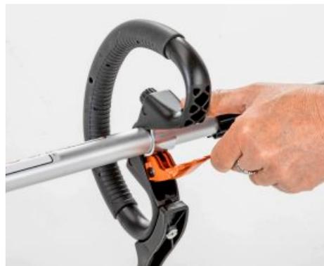
**+ PRAKTISCH:** Der zweite Handgriff wird bei *Stihl* per Hebel gelöst.
