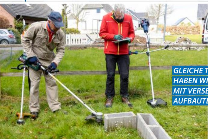
**WECHSEL: BEI ALLEN GETESTETEN FREISCHNEIDERN KÖNNEN VERSCHIEDENE WERKZEUGE MONTIERT WERDEN.**
