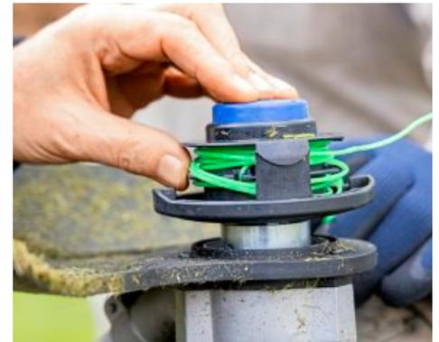
**- KLEMMT:** Bei *Lux-Tools* kann sich der Mähfaden in der Kassette verheddern.
