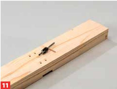
**11** Die Überblattung wird verleimt und verschraubt. Bohren und senken Sie auch hier vier Schraubenlöcher.
