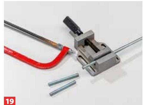
**19** Die Drehachsen bestehen aus M10-Gewindestange. Schneiden Sie die Abschnitte exakt zu.
