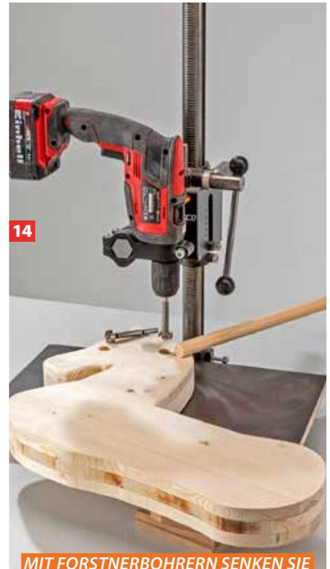
**MIT FORSTNERBOHRERN SENKEN SIE DIE AUGEN ETWA 10 MM TIEF INS HOLZ UND DURCHBOHREN DEN KOPF FÜR DIE HALTESTANGE.**
