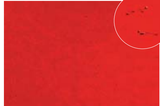
Schlechtes Ergebnis: Haare lösten sich hier von der Plüschrolle, der Auftrag war zudem sehr unregelmäßig
