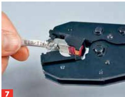
**7** Zugentlastung in Position bringen, Stecker in Crimpzange einführen. Die Kontakte müssen über dem „Kamm“ liegen.
