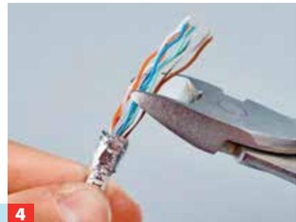
**4** Adernpaket direkt über der Steckbrücke mit einem Seitenschneider möglichst sauber abtrennen
