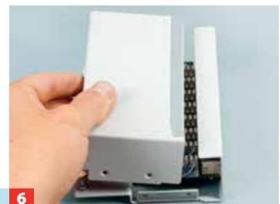
**6** Gehäuse schließen, um auch für den Anschlussbereich eine gute Abschirmung gegen Störfelder sicherzustellen.
