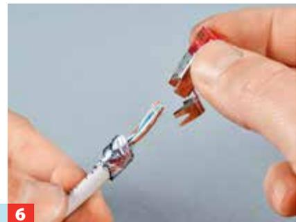
**6** Stecker über die Steckbrücke führen, Adernenden bis an die Kontakte heranhelfen. Zugentlastung zurückbiegen.
