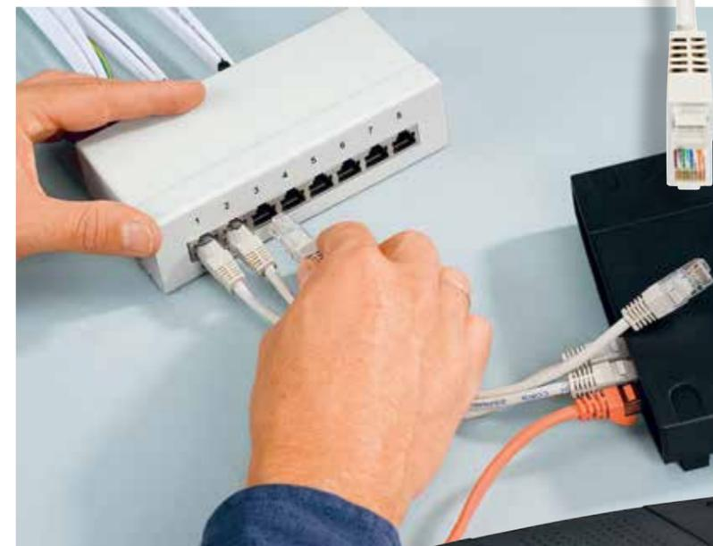
MIT KURZEN PATCHKABELN können Sie entweder einzelne Netzwerkverbindungen direkt untereinander herstellen oder mit einem Switch zu einem Netzwerk vereinen.
