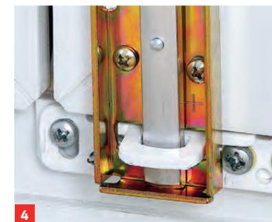
4 Riegelstange mit der Stiftseite in den unteren Schließwinkel stecken und am Getriebekasten anlegen. In Höhe ...
