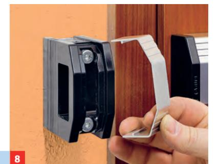
8 Den Schließkasten auf die Anschraubplatte setzen, mit Inbusschrauben befestigen und Abdeckplatte aufstecken.
