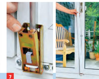
7 Führungsblech aufs Riegelblech setzen und verschrauben. Genauso die obere Stange montieren. Dann die ...
