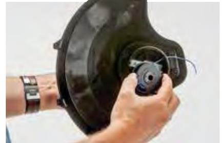
Der Trimmer arbeitet mit einer Fadenspule mit automatischem Nachschub.
