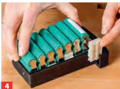
**4** ... wieder an gleicher Stelle anlöten, das Zellenpaket wieder in das Gehäuse setzen und dieses wieder verschrauben.
