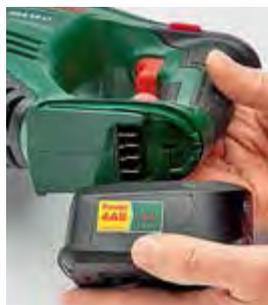
**WECHSEL:** Einige Hersteller (hier Bosch) bieten Akkusysteme, die sowohl in Elektrowerkzeuge als auch Gartengeräte passen.
