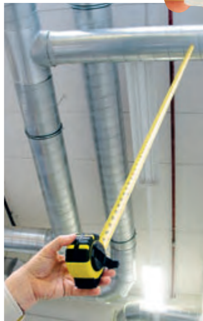
STABILE BÄNDER erlauben Höhenmessungen bis rund vier Meter – bei allerdings höherem Kaufpreis
