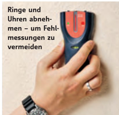
Das Gerät sollte mehrfach über den Messbereich geführt werden
