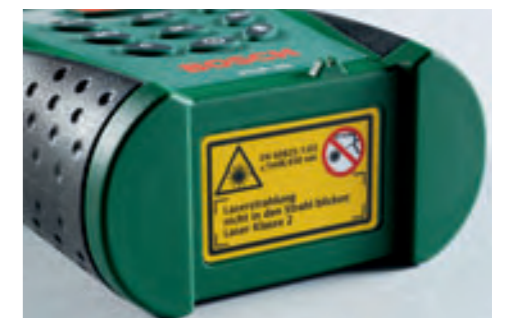
Die Laserklasse bezeichnet die Leistung des eingebauten Lasers
