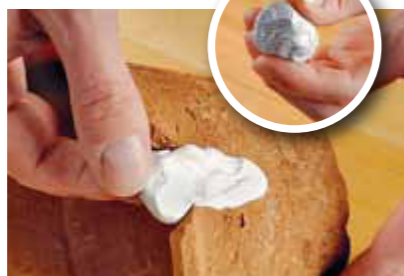
Nach dem Kneten die Masse in die ausgebrochene Stelle setzen und ausformen (Schutzhandschuhe tragen).
