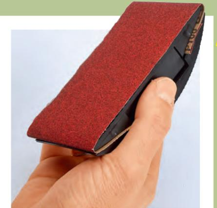
**SCHLEIFKLOTZ:** Sorgt für eine leichtere Handhabung von Schleifpapier.
