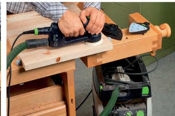
**ABSAUGANSCHLUSS:** Ein entsprechender Stutzen ist heute an praktisch allen spanabhebenden Werkzeugen Standard.
