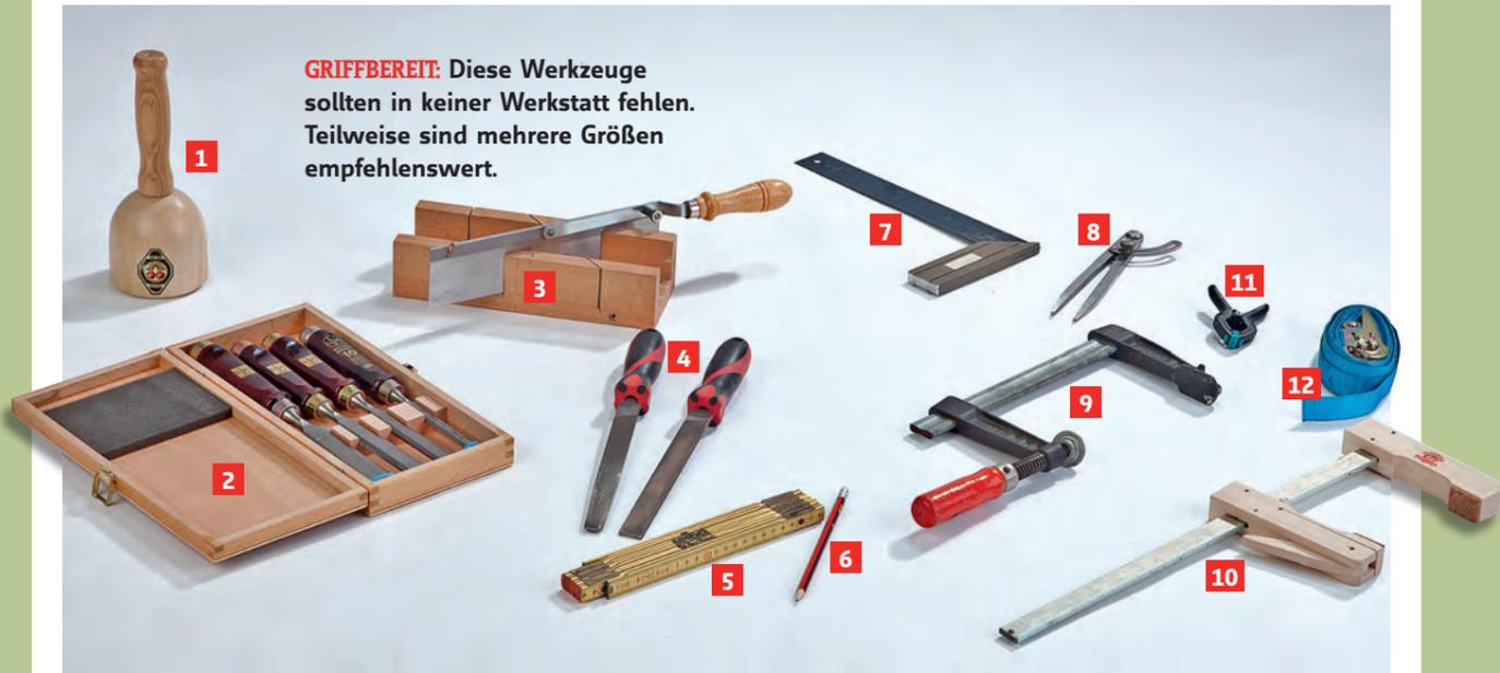
Wichtige Arbeitsgeräte für den Möbelbau: **1** Holzklüpfel zum gefühlvollen Vortreiben von Beiteln und Stemmeisen, **2** Beitel-Satz mit Holzheft, **3** Feinsäge mit umklappbarem Rücken, Schneidlade aus Holz, **4** Feile und Halbrundfeile, **5** Meterstab (Zollstock), **6** weicher Bleistift, **7** Schreinerwinkel, **8** Zirkel, **9** Schraubzwinde, **10** Klemmzwinde, **11** Federzwinde für sehr kleine Werkstücke, **12** Spannband mit Ratsche für sehr große Werkstücke.
