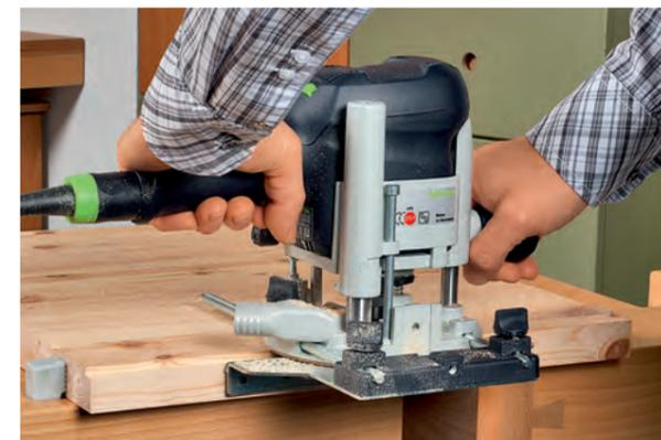
**PARALLELANSCHLAG:** Oberfräsen und Stichsägen werden an der Werkstückkante exakt parallel geführt.
