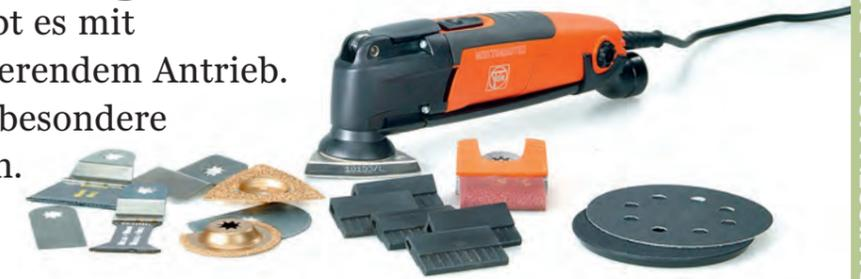
**OSZILLATION:** Der Multimaster von Fein weist derzeit das umfangreichste Zubehör zum Schleifen, Sägen und Polieren auf.
