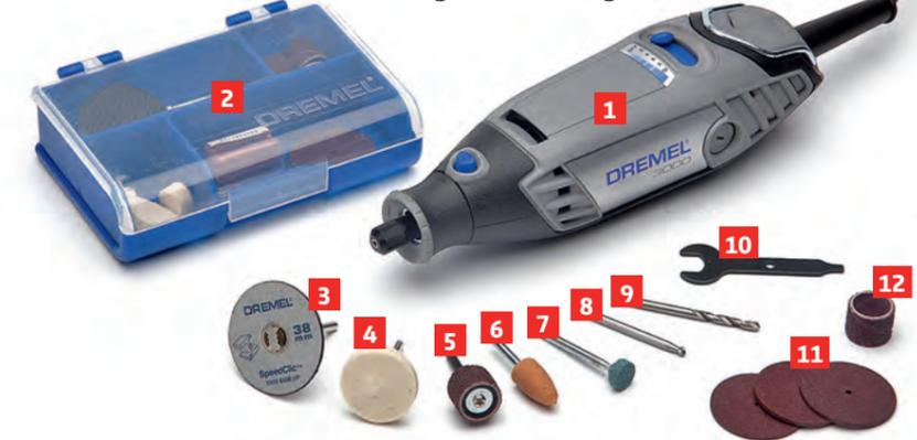
Der Antriebsmotor **1** wird meist mit einer Basisausstattung Zubehör **2** geliefert. Typische Werkzeuge sind: Trennscheibe **3**, Polierscheibe **4**, Schleifrolle **5**, Schleifstift **6**, Schleifpad **7**, Fräser **8** und Bohrer **9**. Mit dem Werkzeug **10** wird das Spannfutter an der Motoreinheit bedient. Einweg-Trennscheiben **11** und Schleifrollen **12** können auf entsprechenden Trägern befestigt werden.
