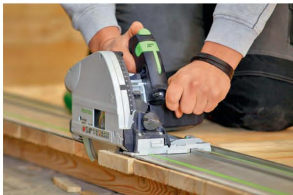
**SÄGESCHIENE:** Sie sorgt für eine präzise Führung von Kreissägen und Oberfräsen – hier beim Ablängen.
