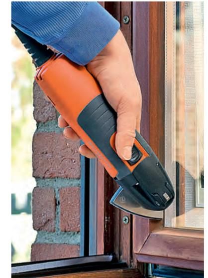
**KANTEN:** Oszillierende Schleifer bewahren sich systembedingt besonders an Innenkanten und in Ecken.
