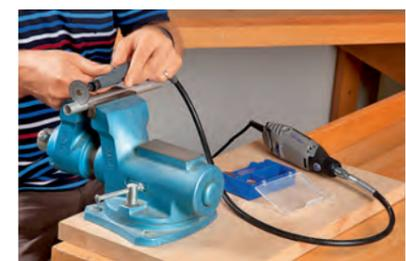
... Werkzeuge möglich, auch werden die Gerätevibrationen entkoppelt.
