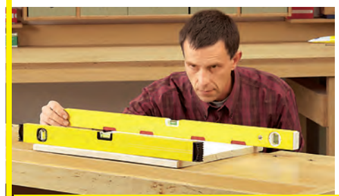
Mithilfe zweier Wasserwaagen erkennen Sie minimale Verformungen; durch Anpeilen eine Drehung und Krümmung des Holzes.
