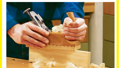
Hobel mit beiden Händen leicht schräg zum Werkstück ausrichten.
