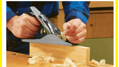
Metallhobel haben meist ausgeformte Griffe.
