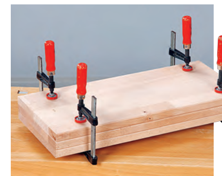
Zur kurzfristigen Aufbewahrung können Platten auch verzwingt werden.
