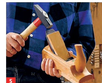
5 Nun den Keil mit leichten Schlägen befestigen. Den Keil jedoch nicht zu fest einschlagen.
