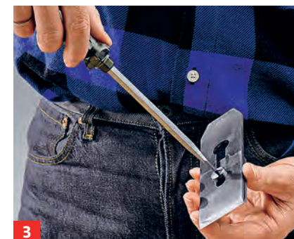
3 Erst nach der Justage die Halteschraube der Klappe gut festziehen.
