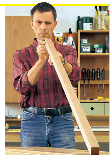
Mithilfe zweier Wasserwaagen erkennen Sie minimale Verformungen; durch Anpeilen eine Drehung und Krümmung des Holzes.
