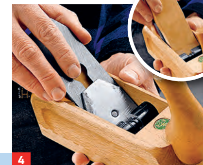
4 Zunächst das Messer vorsichtig ins Hobelmaul einführen, dann den Keil einsetzen und leicht einklemmen.
