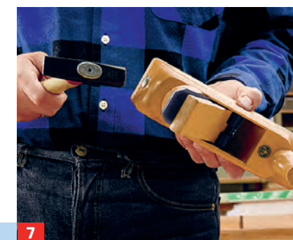
7 Schläge auf den Hobelknopf lösen den Keil – ein leichter Schlag treibt das Messer etwas zurück.
