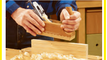
Heben Sie die Hobelsohle ab, wenn Sie zum nächsten Zug ausholen.
