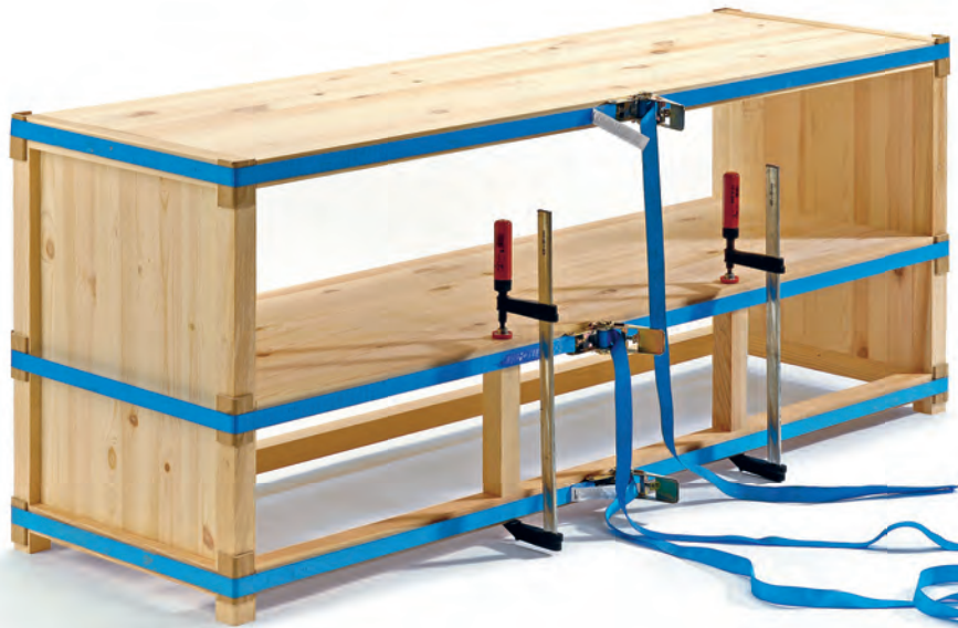
Zum Fixieren von großen Werkstücken eignen sich SPANNGURTE , die Kanten schützen. Sie dabei mit Resten einer stabilen Pappe.
