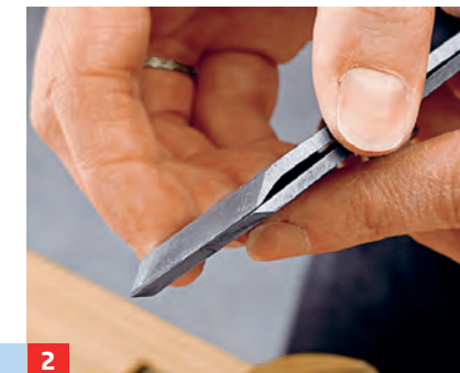
2 ... und schieben Sie die Klappe dann vorsichtig über das Messer. Mit geringem Versatz montieren.
