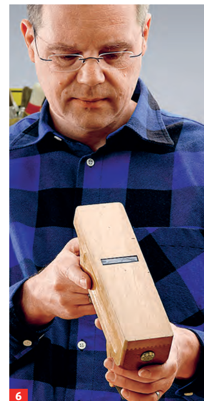
6 Die richtige Lage des Messers stellen Sie bei einer Peilung über die Hobelsohle fest.
