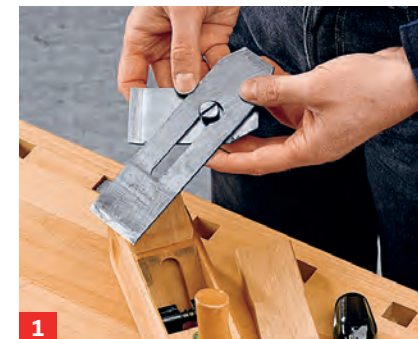
1 Bei Doppelhobeln wird zunächst die Klappe montiert. Führen Sie sie zunächst quer zum Messer ...
