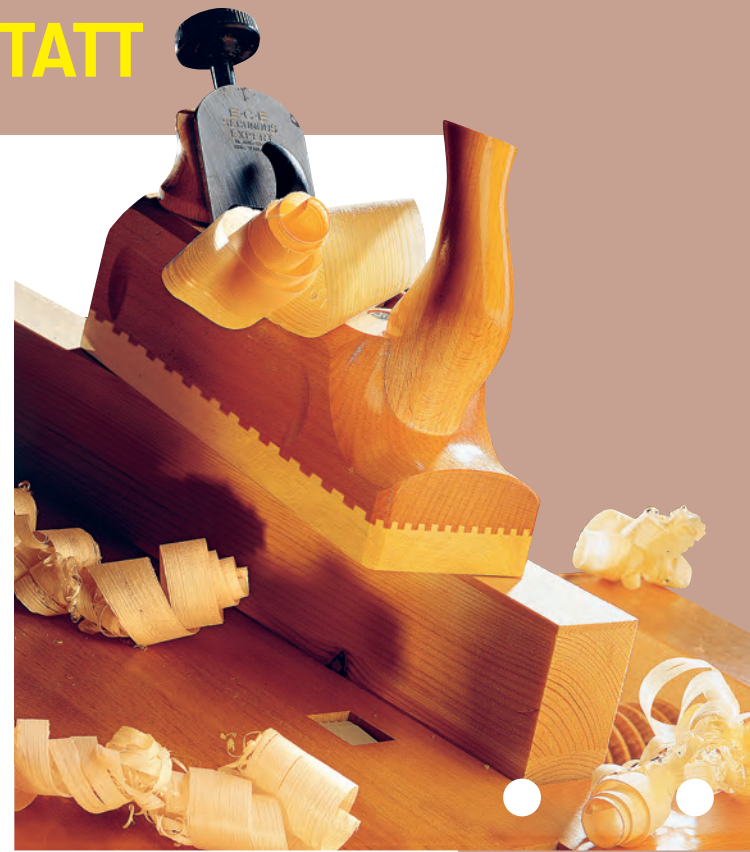
1 Bei Doppelhobeln wird zunächst die Klappe montiert. Führen Sie sie zunächst quer zum Messer ...
