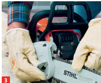
3 ... und auf den Antrieb fädeln. Ketten- deckel schließen, Kette spannen
