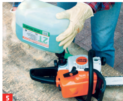
5 Tanken: In der Regel wird 50 Teilen Benzin ein Teil Öl zugemischt
