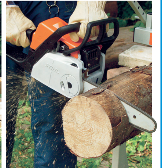
Stämme sicher verankern – am besten auf einem Sägebock oder zum Sägen ausgelegten Klemmhilfen. Stellen Sie sich außerhalb der Sägeebene
