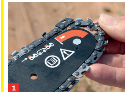
1 Gut: Richtige Laufrichtung und Gefahrenbereich sind gut sichtbar
