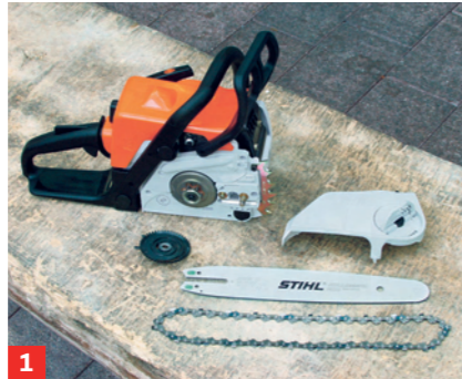
1 Schwert, Kette und Maschine müssen exakt aufeinander abgestimmt sein
