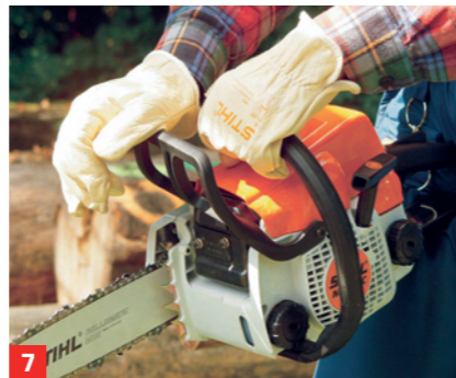
7 ... Motor die Kettenbremse lösen. Gesägt wird nur mit Vollgas
