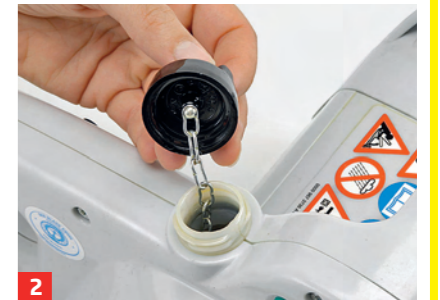
2 Aufpassen beim Ölnachschub: Nur selten ist der Öldeckel unverlierbar
