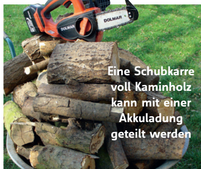
Sicher gegen Rückschlag schützt die Verkleidung der Spitze
