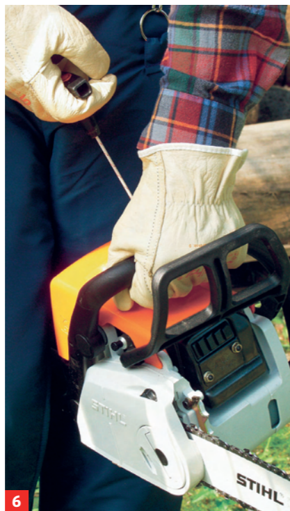
6 Maschine mit eingelegter Ketten- bremsen starten, erst bei laufendem ...
