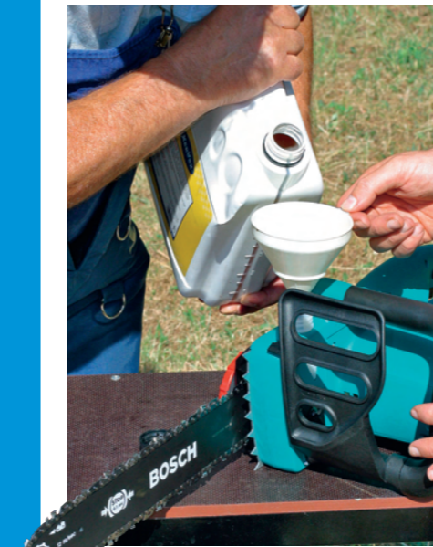
Prüfen Sie regelmäßig den Stand des Sägekettenöls im Vorratstank
