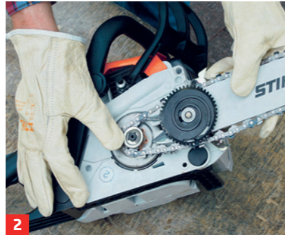
2 Kette montieren: Zunächst auf das Schwert fädeln, dann aufsetzen ...
