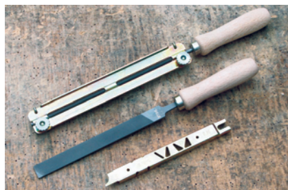
Die richtigen Arbeitswinkel werden mit Feilschablonen eingehalten
