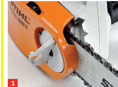
1 Werkzeuglose Kettenspanner sind bei Elektrosägen Stand der Technik
