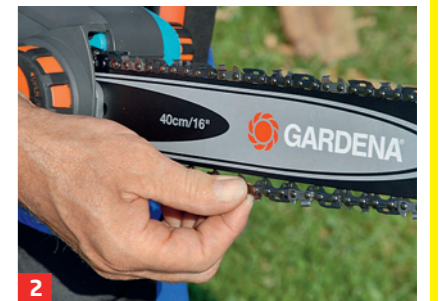
2 Auch bei Elektrosägen muss die Kettenspannung kontrolliert werden
