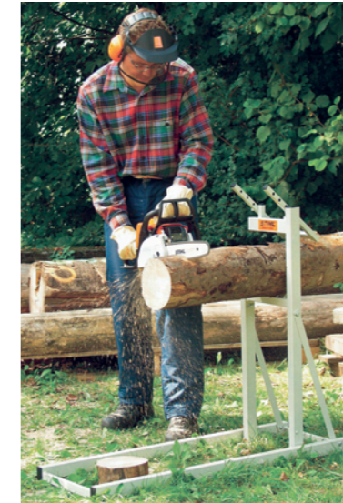
Stämme sicher verankern – am besten auf einem Sägebock oder zum Sägen ausgelegten Klemmhilfen. Stellen Sie sich außerhalb der Sägeebene
