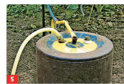
5 Füllen Sie die Walze mit Wasser. Das sorgt für den entsprechenden Druck
