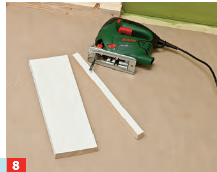
5 ... zuschneiden (hier 35 cm). Es folgt die Montage. Die erste Schindel sollte die Dachlatte seitlich etwa 4 cm überragen.
