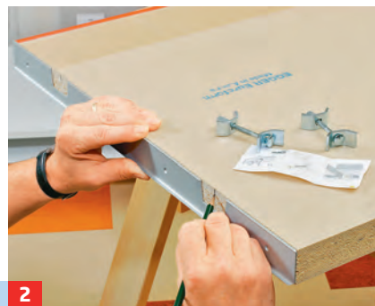
2 Für eine Eckverbindung das Alu-Profil mit den Aussparungen für die Verbinderr anhalten. Positionen markieren!
