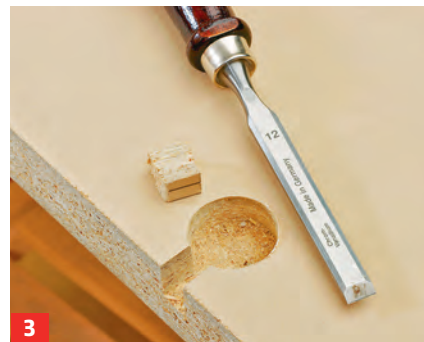
3 Dort mit dem Forstnerbohrer Sacklöcher bohren. Stege für Schraubverbinder schneiden und freistemmen.
