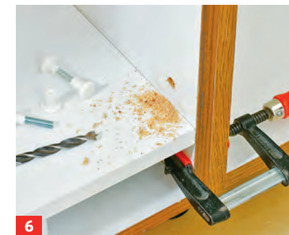
6 Verschrauben Sie alle Korpusse untereinander, aber nicht da, wo später Beschläge montiert werden.
