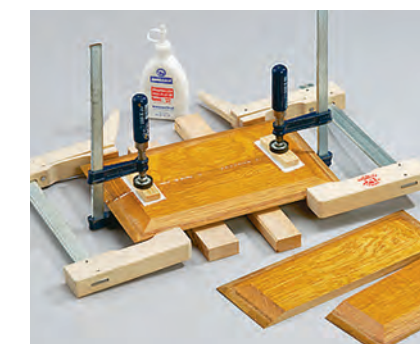
Füllungen aus dem Rahmen nehmen und die Hälften zusammenleimen.
