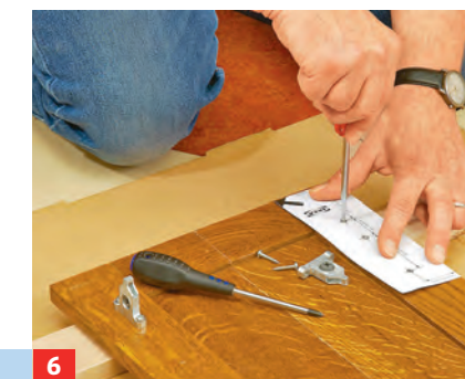
6 Wir haben für die Montage eines Stahlzargen-Auszugs einen Querholzdübel in das Topfbandloch geleimt.
