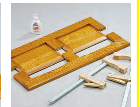
Verleimte Füllungen in den Rahmen setzen und Rahmen verleimen.
