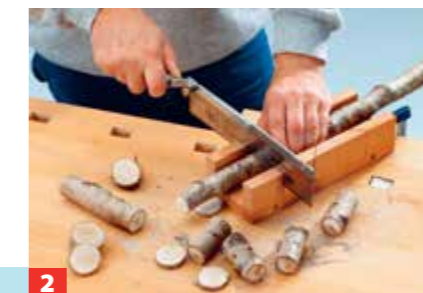
2 Die Birkenäste längen Sie mit der Feinsäge auf die gewünschte Länge ab.
