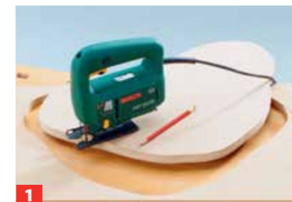
1 Zunächst zeichnen Sie die gewünschte Form auf die Grundplatte. Dann mit der Stichsäge ausschneiden.
