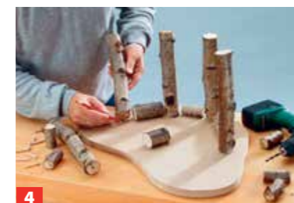
4 Die abgelängten Seiten- und Querstreben auslegen. So ermitteln Sie die Bohrpositionen.
