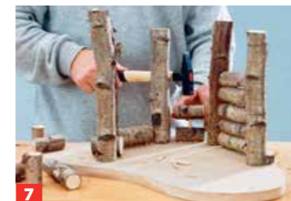
7 ... und miteinander verdübeln. So entstehen nacheinander die beiden geschlossenen Seitenwände.
