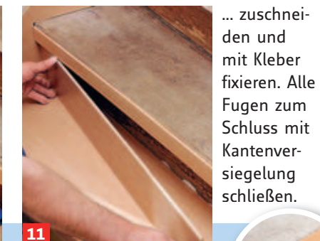
11 ... zuschneiden und mit Kleber fixieren. Alle Fugen zum Schluss mit Kantenversiegelung schließen.
