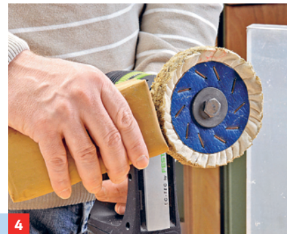
4 Reinigen Sie die Polierscheibe von Wachsresten, dann neue Polierpaste auftragen.
