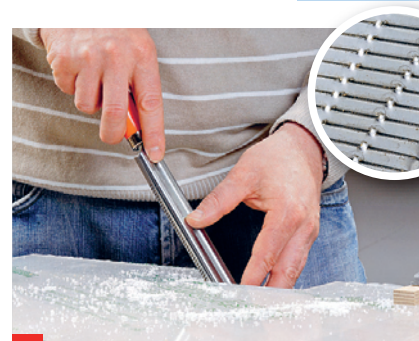
6 Grate entfernen Sie schnell mit einer Kunststofffeile. Sogar leichte Fehler im Schnittverlauf lassen sich so korrigieren.
