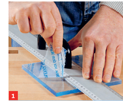
1 Lösen Sie die Schutzfolie nur so weit, dass die Klebestelle frei liegt. Folie über eine Linealkante abziehen.
