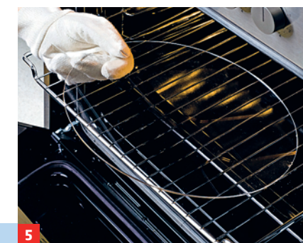
5 Ohne Schutzfolie kommt die Scheibe bei 170 °C für ca. 3-5 Min. in den Umluftherd. Handschuhe tragen!
