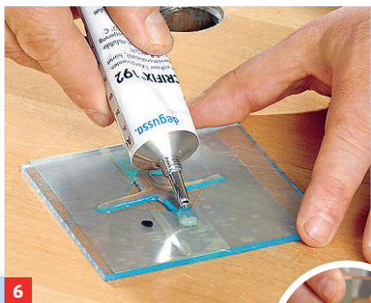
6 ... kreuzweise diagonal aufgetragen und der Quader passend aufgesetzt.
