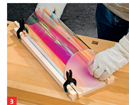
3 Liegt die beschichtete Seite außen, bleibt Acrylglas transparent. Für gleichmäßige Rundungen: Scheibe einspannen.
