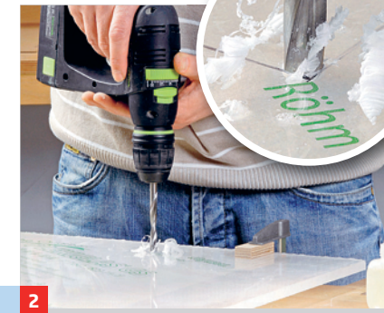
2 Mit sanftem Druck bohren Sie in die Platte. Beobachten Sie den Spanfluss, so erkennen Sie, ob der Vorschub stimmt.
