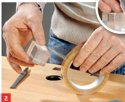
2 Alle nicht zu verklebenden Teile abkleben – hier an einem Massivkörper.
