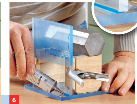
6 Fahren Sie mit dem fugenfüllenden Kleber an der Kante entlang – er kriecht in den Klebespalt hinein.
