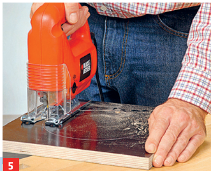
5 Form fertigen: Mit der Stichsäge die Kuppel-Außenform gleichmäßig ausschneiden. Mit Schleifpapier glätten.
