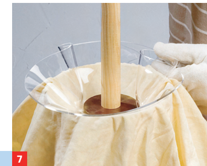
7 Mit dem Stab drücken Sie die Platte in Form – den Rand mit den Händen modellieren. Halten, bis Material ausgekühlt ist.
