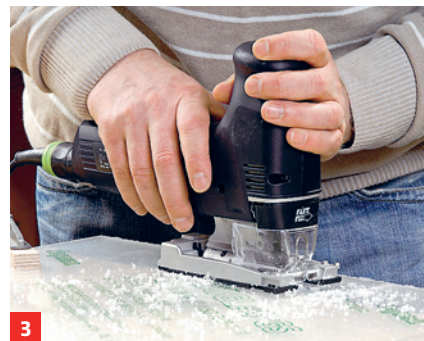
3 Innenecken dürfen niemals scharfkantig gesägt werden! Eine Bohrung rundet die Ecke und schützt vor Rissen.
