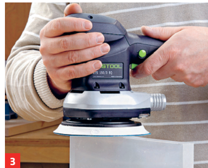
3 Nun in drei Schritten (grob/mittel/fein) die Kanten glattschleifen – optimal sind die Körnungen 400/800/1200.
