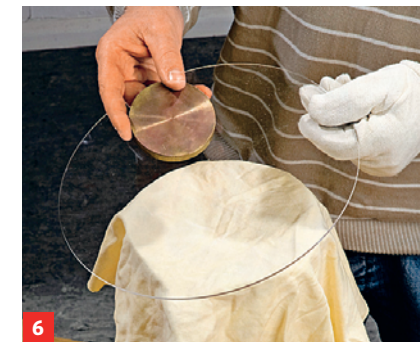
6 Stülpen Sie Handschuhstoff (Baumwolle) über das Rohr, dann legen Sie Acrylglas und die Metallscheibe auf.
