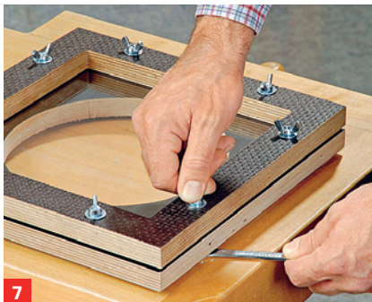
7 Dann gehts los: Acrylglas einsetzen, Form schließen, Flügelschrauben mit Unterlegscheiben montieren und festziehen.
