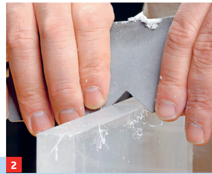
2 Mit der Dreieckskerbe entgraten Sie gleichzeitig beide Kanten. Gleichmäßiger Spanfluss zeigt den richtigen Druck an.
