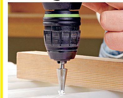
■ Kegelbohrer: Der einschneidige Bohrer-aufsatz verhindert zuverlässig das Ausreißen des Materials auf der Unterseite – auch in ungeübten Händen.
