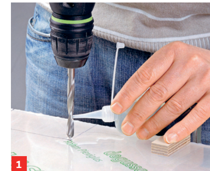
1 Ehe Sie den Bohrer starten, geben Sie üppig Kühlmittel (günstig: Leitungswasser mit Spülmittel) an.
