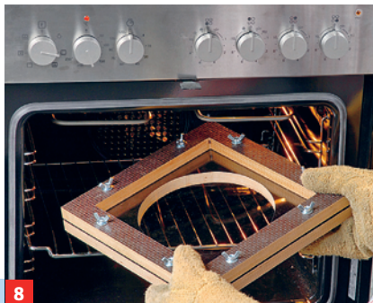
8 Der Rahmen wird einfach bei 170 °C auf das Gitterrost des Backofens gelegt. Der Ofen wird dabei nicht verschmutzt.
