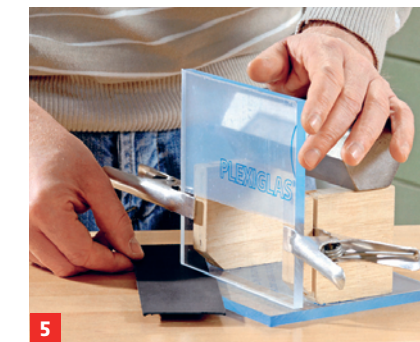
5 Ein Streifen Tonkarton schafft einen gleichbleibend dünnen Spalt zwischen den zu verklebenden Platten.
