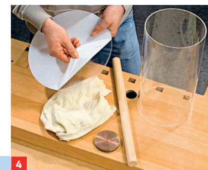
4 Für eine Wellenschale benötigen Sie: Acrylglas-Scheibe (Ø = 300 mm, d = 3 mm), Rohr, Stoff und eine Metallplatte.
