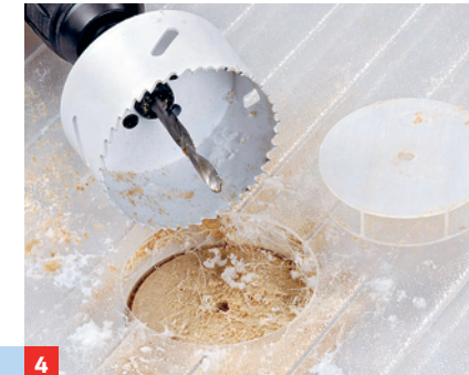
4 Damit die Platte auf der Unterseite nicht ausreißt, sollten Sie eine Zulage unterlegen (z.B. aus Holz).
