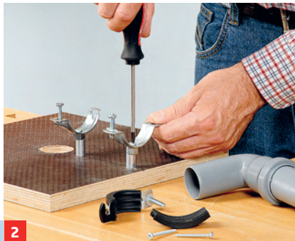
2 Rohrmuffen mit den Abstandhaltern auf die Grundplatte montieren, sodass ...
