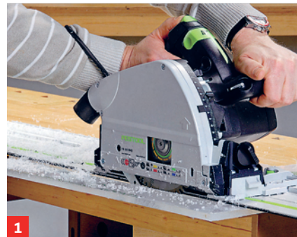
1 Mit der Handkreissäge und dem richtigen Sägeblatt (siehe selbst Produktinfo) lässt sich Acrylglas leicht trennen.
