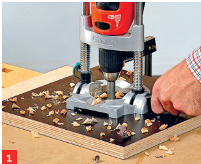
1 Lufttisch herstellen: Bohren Sie mit einem 40-mm-Forstnerbohrer die zentrale Luftbohrung.
