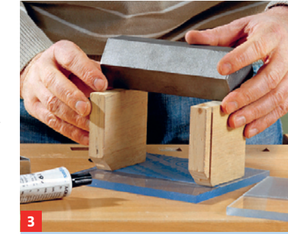
3 Eine Hilfskonstruktion aus Restholz fixiert die Werkstücke während der Aushärtung des Klebers.
