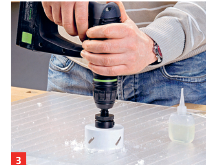
3 Große Durchlässe, z.B. in Doppelstegplatten für Bedachungen, bohren Sie mit der Lochsäge.
