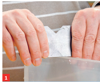
1 Mit festem Druck ziehen Sie die Stahlklinge über die Plattenkante. Ein HSS-Sägeblatt ist eine günstige Alternative.
