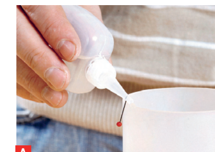
A Füllen Sie nur kleine Mengen Kleber in ein Ölerfläschchen um – so lässt er sich leichter dosieren. Die Nadel dient als Führung.
