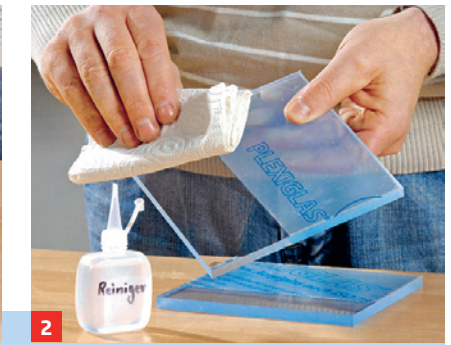
2 Flächen und Kanten müssen fettfrei sein: Reinigen Sie die Klebestellen mit Feuerzeugbenzin oder Isopropanol.
