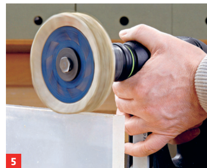
5 Bei mittlerem Anpressdruck polieren Sie nun die Kante wieder auf Hochglanz.
