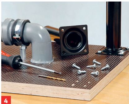
4 Möbelfüße sorgen später für sicheren Stand auf Tisch oder Werkbank.
