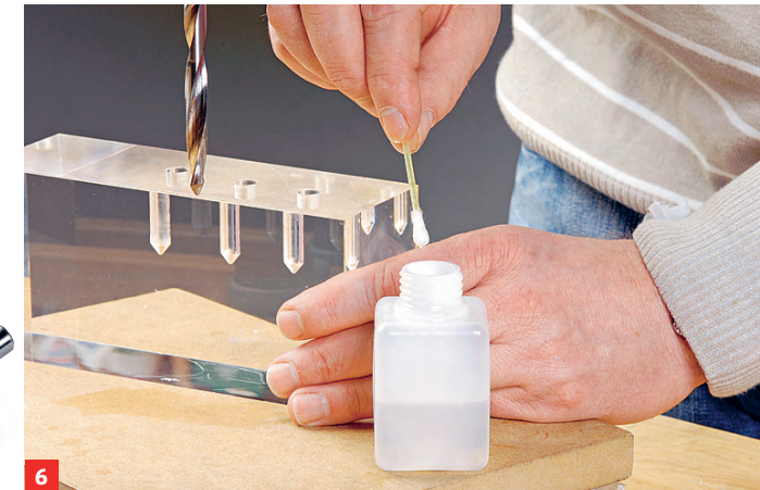
■ Kegelbohrer: Der einschneidige Bohrer-aufsatz verhindert zuverlässig das Ausreißen des Materials auf der Unterseite – auch in ungeübten Händen.
