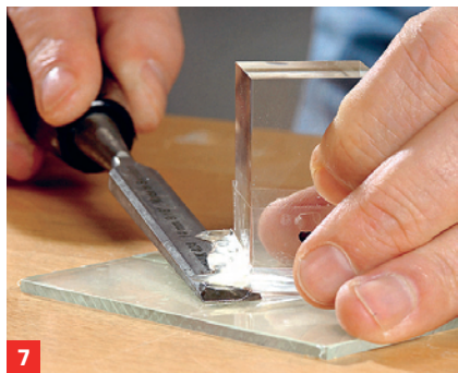
7 Nach dem Aushärten am Tageslicht können Sie überschüssigen Kleber leicht mit einem Beitel abheben.
