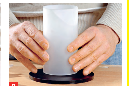
B Ist der Rand umlaufend mit Klebstoff benetzt, Rohr auf Kreisabschnitt setzen und andrücken. Kleber aushärten lassen.
