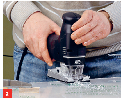
2 Für filigrane Ausschnitte ist die Stichsäge (ohne Pendelhub) erste Wahl. Sägestelle möglichst kühlen.
