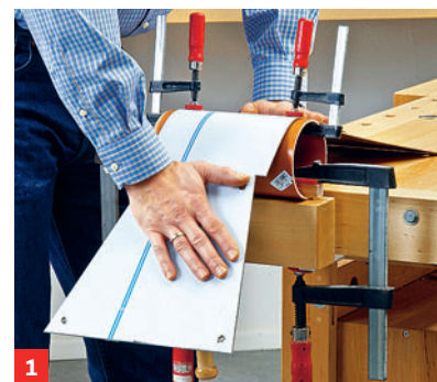
1 Große Radien können über Kunststoffrohren gebogen werden, ...
