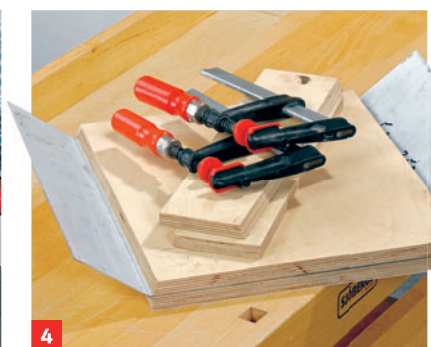
4 Auf diese Weise bleiben die Umgebungsflächen exakt gerade
