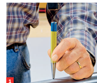
1 Innengewinde: Mit einem Körner die geplante Bohrstelle leicht ankören
