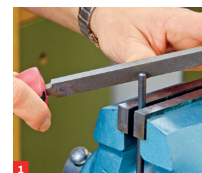
1 Außengewinde: Feilen Sie eine Kegelform an die Metall-Rundstange
