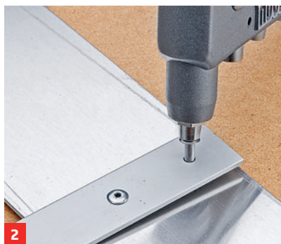
2 Niet in Nietzange einsetzen, Nietstift in Bohrloch einführen ...
