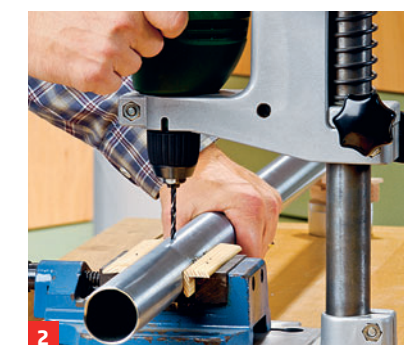
2 Mit der zur Gewindegröße passenden Bohrergröße vorbohren
