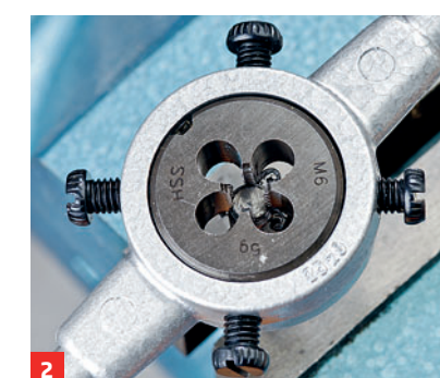
2 Das Gewinde wird mit nur einem Werkzeug in einem Zug geschnitten
