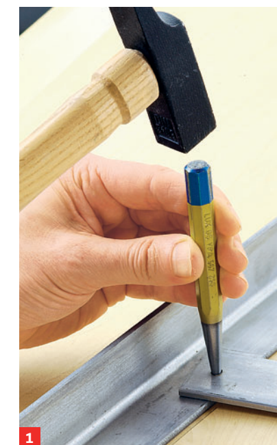
1 Bohrstelle ankören, damit die Schneide des Bohrers greifen kann
