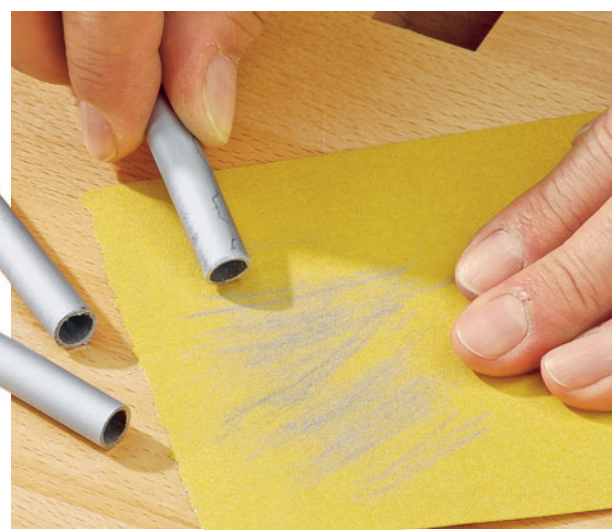
ENTGRATEN: Runde Werkstücke können auch mit feinem Schleifpapier (Körnung zum Beispiel 120) entgratet werden. Das Schleifpapier aber danach nicht mehr für die Holzbearbeitung einsetzen!
