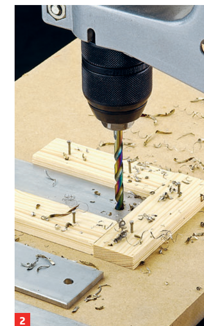
2 Bohren Sie das fixierte Werkstück mit reduzierter Drehzahl
