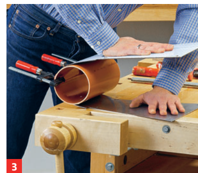
3 Fixieren Sie das Metall an der Form, damit die Rundung genau ...
