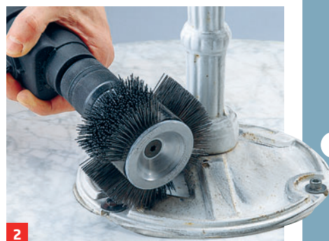
2 Mit Drahtbürste, Schleifpapier oder Stahlwolle zunächst Rost entfernen
