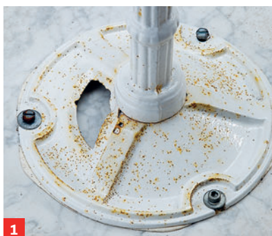
1 Typischer leichter Rostbefall einer lackierten Metalloberfläche
