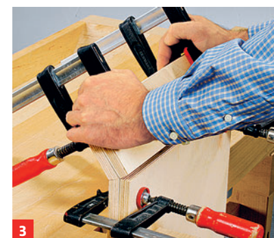
3 So kann die Biegekraft exakt auf die Biegekante konzentriert werden
