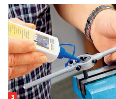
3 Dabei die Schneiden des Eisens immer wieder mit Schneidöl benetzen
