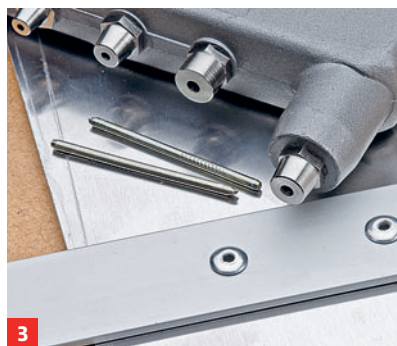
3 ... und Zange wiederholt abdrücken. Schließlich bricht der Nietschaft
