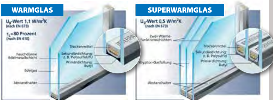
Wer heute einen Wintergarten kauft, erhält Glasscheiben mit U-Werten von 1,0 bis 1,2 \text{ W/m}^2\text{K} . Ein kalter Kasten wie früher einmal ist so kein Thema mehr.
