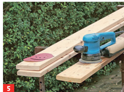
5 Mit einem Exzenterschleifer wird der alte Lack restlos entfernt
