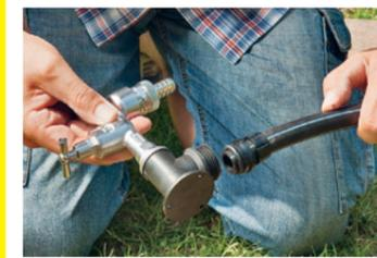
Drehen Sie das Zapfventil in die Wanddose und verschrauben Sie diese am gewünschten Ort
