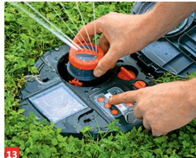
13 Der mit einer eigenen Verlegeleitung gespeiste Konturenregner wird extra auf die präzisen Wurfweiten programmiert
