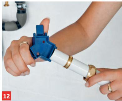
**12** Das Rohr muss für eine dichte Verbindung kalibriert werden. Dorn (blau) bis zum Anschlag ins Rohr schieben
