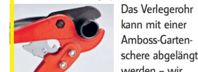
Das Verlegerohr kann mit einer Amboss-Gartenschere abgelängt werden – wir empfehlen aber den Kauf einer Schere für Kunststoffrohre, wie sie für Trinkwasserleitungen verwendet wird, denn damit wird das Rohr sauber getrennt. Je nach Verlegesituation gibt es die Verbindere in verschiedenen Anschlussvarianten.
