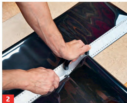
1 Messen Sie Höhe und Breite der Scheibe ab Dichtungskante. Bei großen Flächen kann die Folie angesetzt werden.
