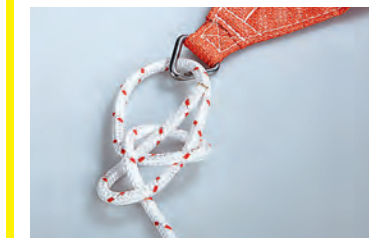
... und wieder in gleicher Richtung durch das Auge hindurch.
