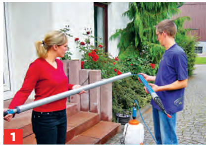
1 Erst die Teleskoplanze zusammensetzen. 1) Grundlänge: 3,80 m. Im Hintergrund: Die nötige Kanisterpumpe.
