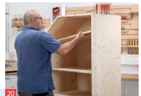
20 Die Bodenträger an den gewünschten Positionen einstecken und die Böden einlegen. Alternativ eine Kleiderstange montieren.
