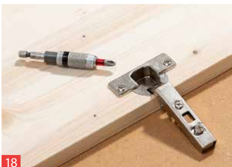
18 Nun stecken Sie die Topfbänder in die Löcher, richten sie mit einem Winkel aus und schrauben sie fest.
