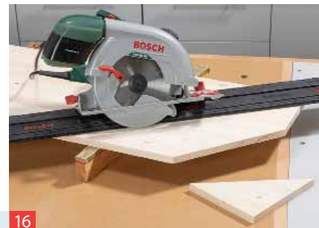
16 Die linke Schranktür muss natürlich einen Schrägschnitt erhalten. Jede Tür wird mit vier Topfbändern angeschlagen.
