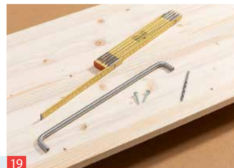
19 Legen Sie die Positionen der Bügelgriffe fest. Dann die Löcher markieren, bohren und die Griffe festschrauben.
