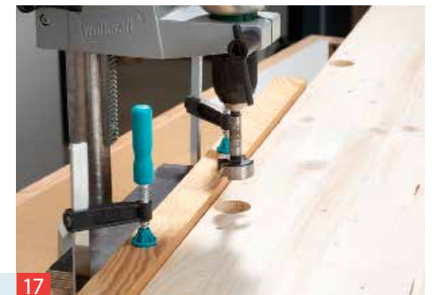
17 Die Löcher dafür schneiden Sie am besten mit einem Forstnerbohrer und der Ständerbohrmaschine. Beachten Sie die Bohrtiefe!
