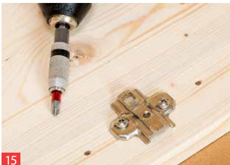
15 Die Kreuzmontageplatten in den Lochreihen am Korpus montieren, ggf. dort, wo keine Lochreihe ist, neue Löcher bohren.
