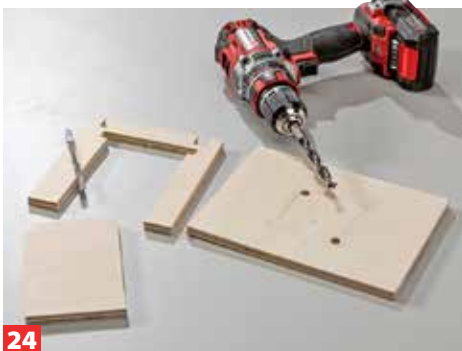
Durchbohren Sie die Ecken und trennen Sie dann die Flächen für Fenster und Türen heraus.
