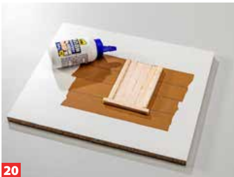
20 Das Setzen einer Zwinge ist hier schwierig – wir haben die Tür einfach auf der Grundplatte trocknen lassen.
