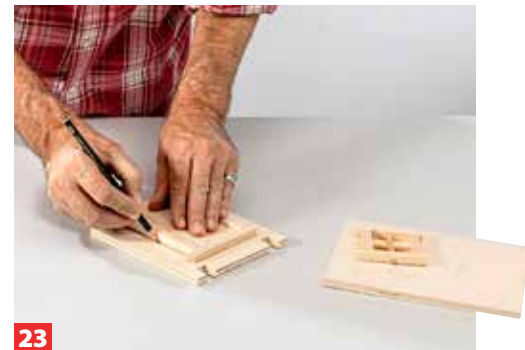
Legen Sie die Bauelemente auf die zugehörigen Wandflächen, richten Sie sie dort aus und markieren Sie die Umriss.
