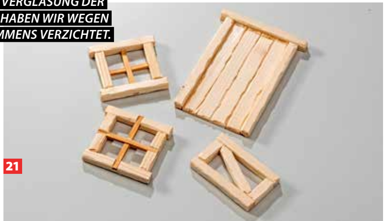
18 Sind die Rahmen für das Kreuz ausgeklinkt, leimen Sie es ein und fixieren es mit kleinen Leimklammern.
