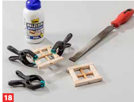
18 Sind die Rahmen für das Kreuz ausgeklinkt, leimen Sie es ein und fixieren es mit kleinen Leimklammern.
