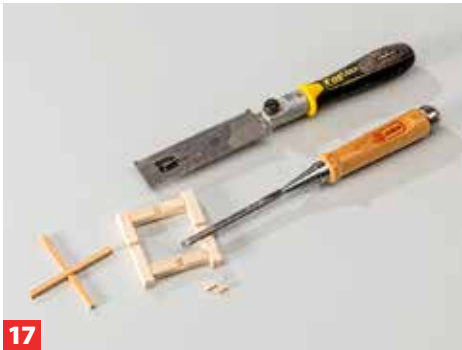
17 Anschließend wird das Fensterkreuz komplett in die innenliegende Rahmenfläche eingelassen.
