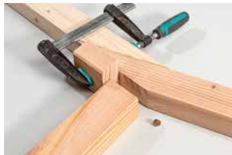
14 Mit Dübel-Markierstiften übertragen Sie dann die Dübellöcher der Schrägseite auf das Bein-Lehnen-Bauteil. Die andere Seite ...
