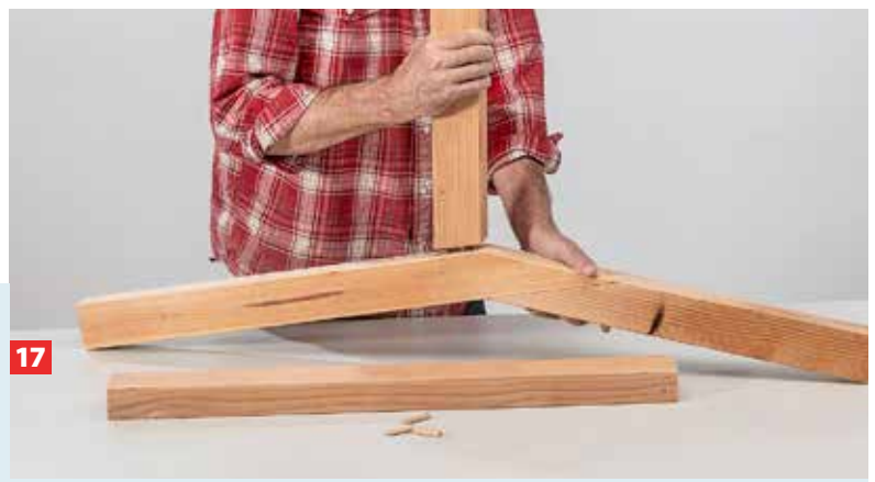
14 Mit Dübel-Markierstiften übertragen Sie dann die Dübellöcher der Schrägseite auf das Bein-Lehnen-Bauteil. Die andere Seite ...
