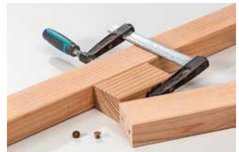
15 ... auf das Vorderbein übertragen. Spannen Sie dazu in beiden Fällen ein Anschlagsholz in der richtigen Höhe auf.
