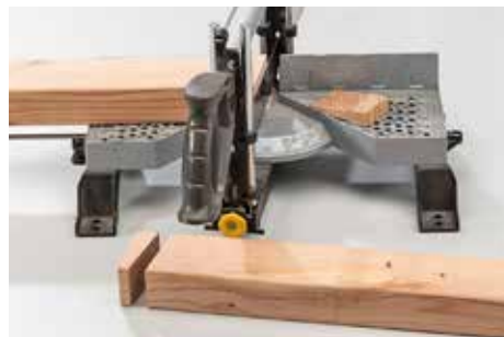
12 Weiter geht es nun mit der Seitenstrebe zum Vorderbein. Da die Strebe am schräg stehenden Hinterbein ansetzt, muss sie auch ...
