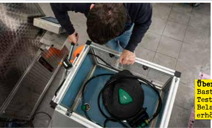
**Überdrucktest bei der VPA:** Bastian Rauh unterzog alle Testkandidaten einer Belastungsprüfung mit erhöhtem Wasserdruck.
