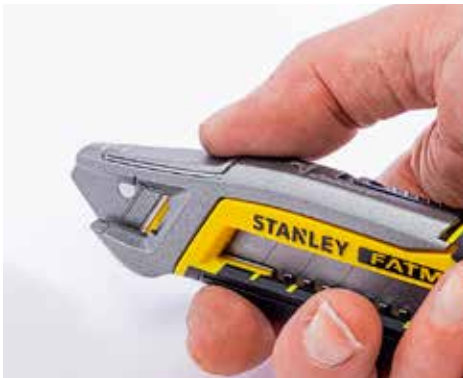
RUTSCHIG: Bei einigen Stanley-Modellen fehlt oben eine Gummierung.
