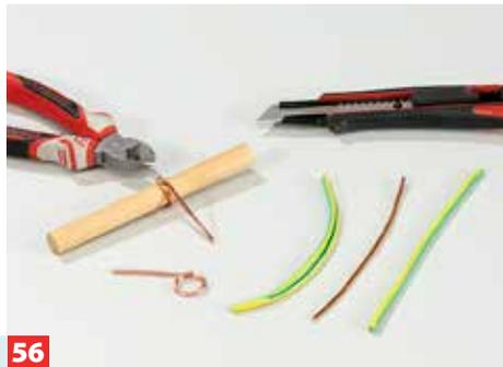
**56** ... dort einhängen. Aus abisoliertem 2,5-mm-Erdungsdraht haben wir zwei Drahtstecker gebogen. Bohren Sie anschließend ...
