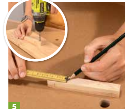
5 ... kürzer sein, Bohrpositionen anzeichnen und vorbohren.
