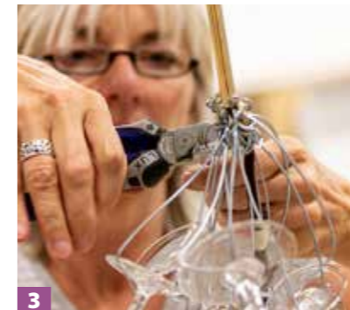
3 Überstehende Enden mit dem Seitenschneider abknipsen.
