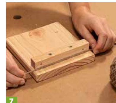
7 Zwischen Leiste und Dachhälfte ein Juteband legen für die Aufhängung.
