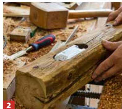
2 Der Trafo wird im Balken versteckt, Aussparung dafür ausstemmen.
