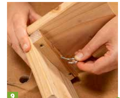
9 Schraubhaken für den Meisenknödel in die Mitte der Leiste drehen.
