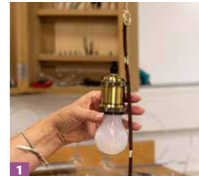
1 Stoffkabel durch Stab und Baldachin ziehen, Fassung markieren.
