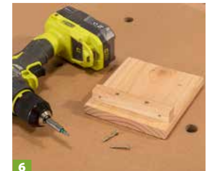
6 Anschließend schrauben Sie die Leiste an die längere Dachhälfte.
