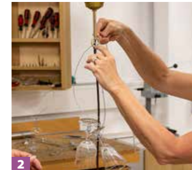
2 Die vorbereiteten Objekte mit einer Zange am Ring befestigen.
