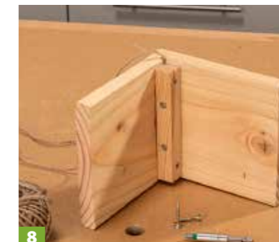
8 Nun die zweite, kürzere Dachhälfte an die Leiste schrauben.
