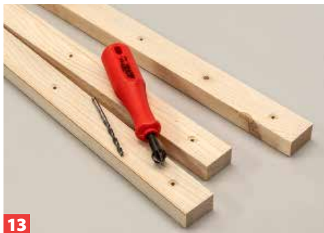
13 Die Schubkästen laufen auf dem Boden. Mit drei Führungsschienen geben Sie die Laufrichtung vor und begrenzen sie.
