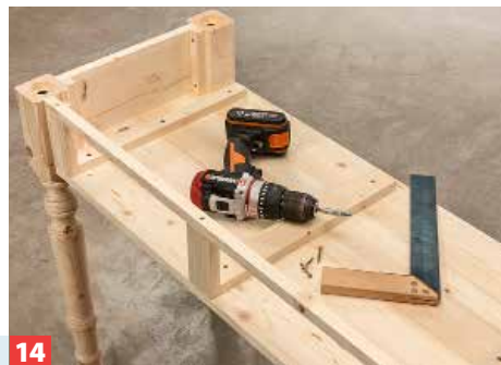
14 Achten Sie darauf, die Leisten parallel und mit etwas Spiel zu den später gebauten Schubkästen zu montieren.
