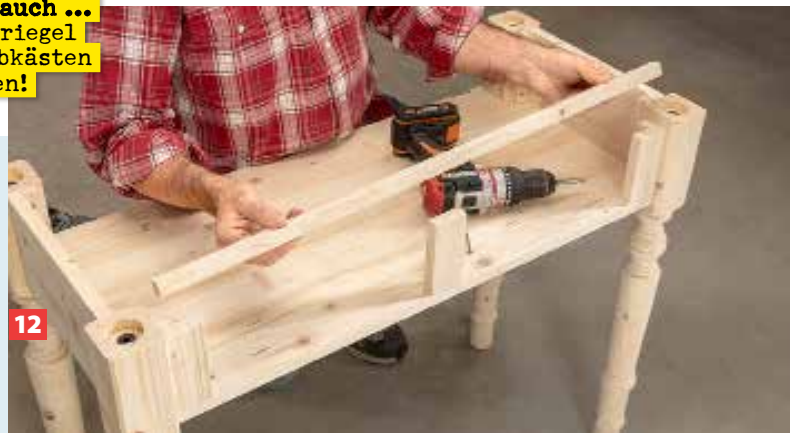
9 Verschrauben Sie die Platte von außen durch die Seitenzargen. Unbedingt vorbohren und senken!
