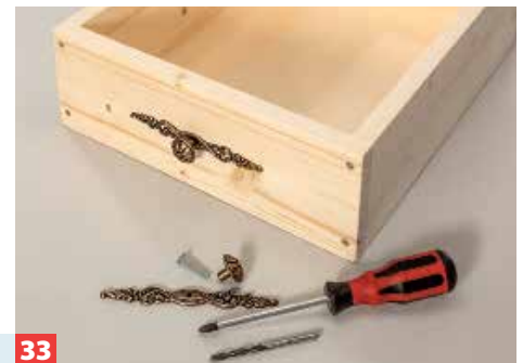
33 Die Beschläge montieren Sie am besten erst nach dem Verspachteln und Lackieren der Schubkästen.
