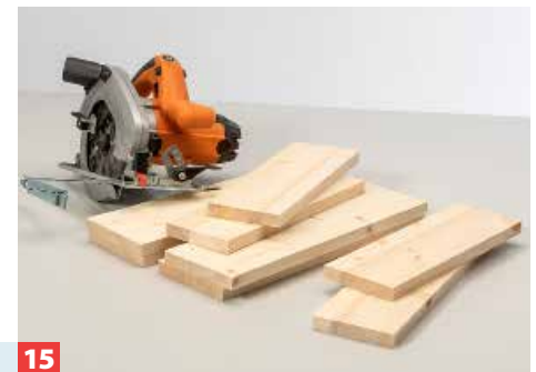
15 Weiter geht es mit dem Bau der Schubkästen: Schneiden Sie die erforderlichen Bauteile mit der Handkreissäge zu.
