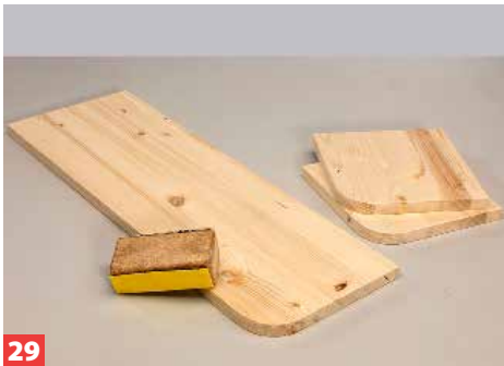
29 Nach dem Zuschnitt mit der Stichsäge schleifen Sie die Schnittkanten sorgfältig.
