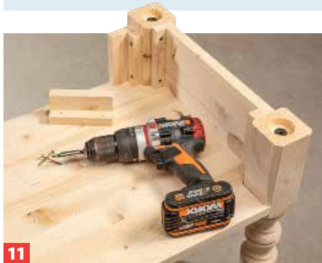
11 Die vorderen Anschlussstücke sind niedriger als die Seitenteile. Schrauben Sie sie fest.
