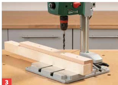
3 ... verhindern, dass die Bauteile dabei verrutschen. In die Beine bohren Sie mit der Ständerbohrmaschine vier Löcher.
