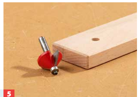
5 ... gebohrt; zwei davon als Sacklöcher. Fasen Sie mit der Oberfräse und einem Fasenfräser mit Anlaufing bei allen Bauteilen die Kanten.
