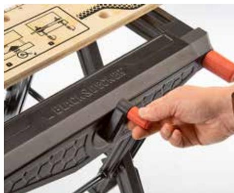
**+ SCHNELLER:** Bei *Black&Decker* erleichtert eine Kurbel den Spannvorgang.
