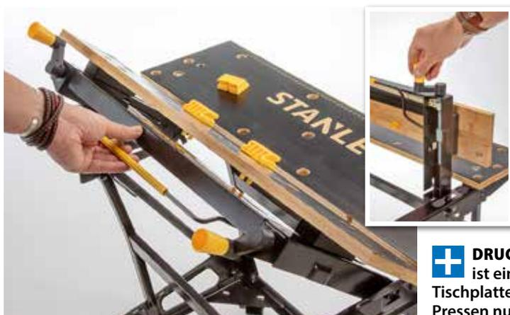
**+ DRUCK:** Bei *Stanley* ist ein Teil der Tischplatte zum vertikalen Pressen nutzbar.
