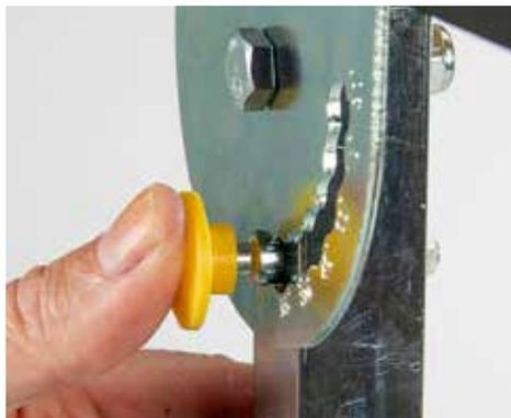
**- KLEMMT:** Bei *Newpo* ist der Verstellknopf für ein Anwinkeln kaum nutzbar.
