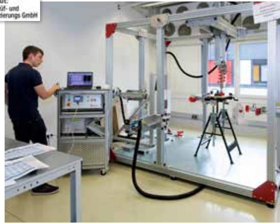
**BELASTUNG:** In diesem VPA-Prüfstand wurde getestet, ob die Tische der angegebenen Traglast standhalten.
