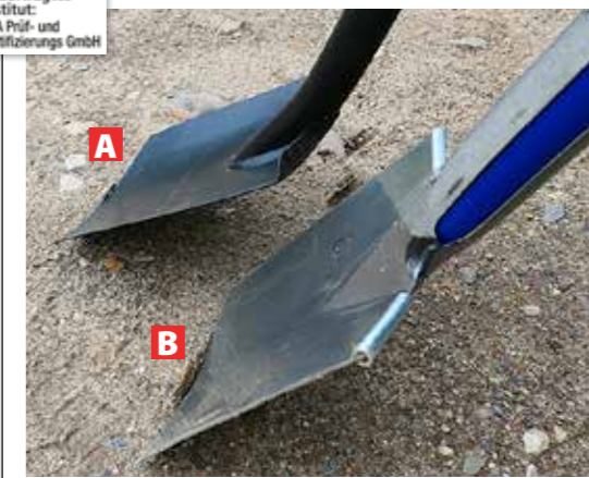
WINKEL: Die ergonomisch geformten Spaten sind am Blatt stärker angewinkelt A als die klassischen Modelle B – das kann beim Umgraben stören.
