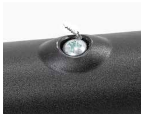
STÖRT: Ein Grat kann an einem Fiskars -Spaten zu Verletzungen führen.
