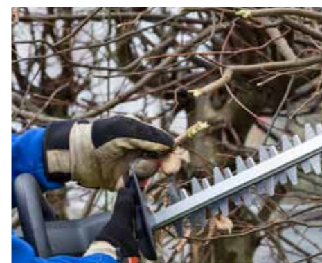
- UNSCHÖN: Die Ryobi beschädigt dickere Äste, trennt sie aber nicht ab.
