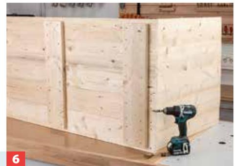
Die erste Seitenwand verschrauben Sie nun leicht eingerückt von unten mit dem Boden. Hier auch in das Kopfholz vorbohren!
