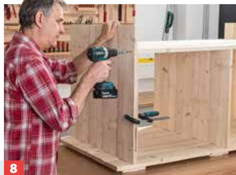
... Schraubenkerns das Kopfholz vorbohren! Den Zwischenboden Brett für Brett mit den Seiten und auf der Mittelwand festschrauben.
