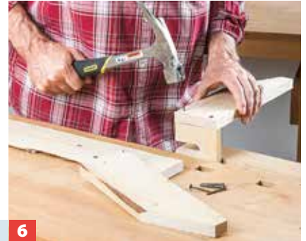
6 Mit Nägeln verbinden Sie nun die Seitenteile mit der Glas-Halteleiste. Vorsichtig, damit das eingesägte Brett nicht bricht!
