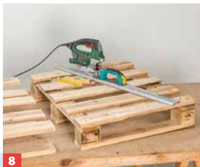
8 Eine weitere Palette wird entlang der Mittelklötze rechtwinklig zugeschnitten.
