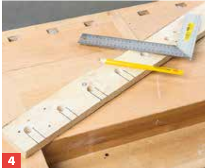
4 Nach dem Durchbohren zeichnen Sie von der Vorderkante aus senkrechte parallele Linien bis auf die seitlichen Lochränder.
