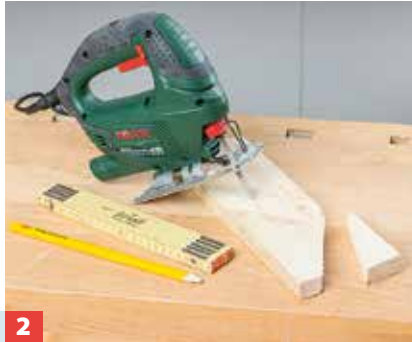
2 Zwei 310 mm lange und 90 mm breite Seitenteile nach oben hin gleichmäßig schräg anzeichnen und zuschneiden.
