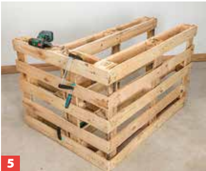
5 Die Zwischenpalette ebenso anbringen; die Montage des gesamten Werkzeugs sollte auf der Seite liegend erfolgen.
