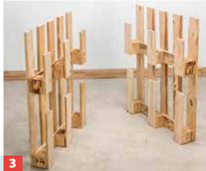
3 Für die Zwischenablage unterhalb der Mittelklötze wird ebenfalls eine Aussparung in Palettenhöhe vorgenommen.
