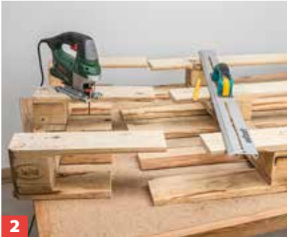
2 Die Rückseite schneiden Sie um die Palettenstärke niedriger zu.
