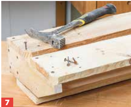
7 Auf gleiche Art und Weise den Flaschen-Stellboden, die Front und die Rückenbretter anheften. Am besten vorbohren!
