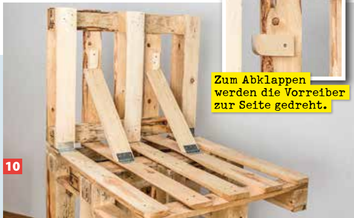
Mit Bändern werden das Klapp-Element und die Stützstreben montiert. Zwei drehbare Vorreiber sichern die Streben.
