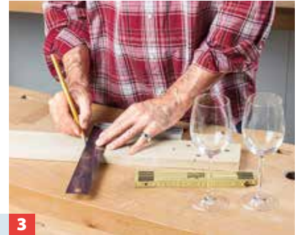
3 Die angegebenen Abstände der Wein-glas-Kämmung sollten zumeist funktionieren, hängen aber vom Glasmaß ab.
