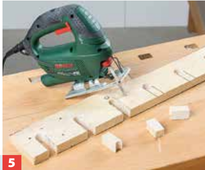
5 Dort entlang schneiden Sie mit der Stichsäge das Holz zum Einhängen der Glasstiele aus.
