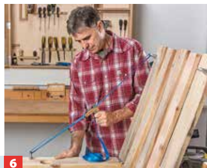
6 ... vier stabile Ringschrauben. Hierdurch den Zurrurt führen und den Winkel der Lehne mit der Ratsche einstellen.
