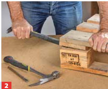
2 Lösen Sie davon die komplette Deckbrett-Platte: zunächst mit Zimmermannshammer und Meißel, danach mit dem Kuhfuß.
