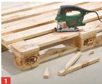
1 Oberstes und unterstes Brett bleiben komplett, die Zwischenbretter werden jeweils mit der Stichsäge ausgeklinkt.
