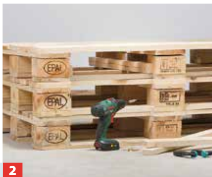
2 In der oberen Palette werden pro Seite jeweils zwei Laufleisten angebracht, die als Führung für die Fußstützen dienen.
