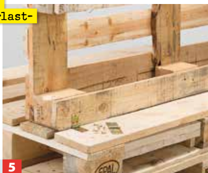
5 Die Rückenlehne im hinteren Drittel auf die Sitzfläche stellen und die Rückseite mit Scharnieren verschrauben.
