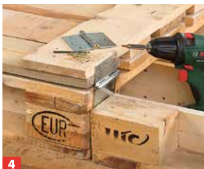
4 Nun wird die in Bild 2 gelöste Deckbrett-Platte mit Scharnieren an der unteren Palette angeschlagen.
