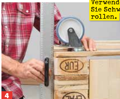
4 Beachten Sie beim Anschrauben der Rollen, dass diese nicht über die Palettenränder hinausragen.
