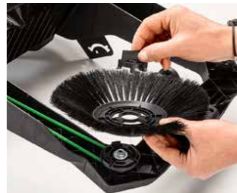
+ WERKZEUGLOS: Einfacher Wechsel der Frontbesen bei Litake .
