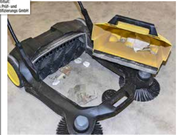
- SCHIEBER: Einige der Kehrmaschinen schieben größere Gegenstände zwar zusammen, sammeln sie jedoch nicht ein – hier bei Kärcher .
