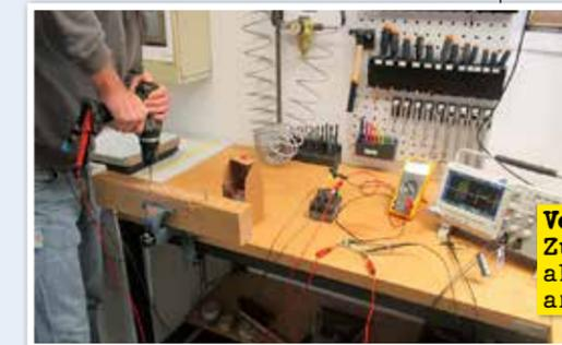
**Versuchsaufbau beim TÜV:** Zum Entladen der Werkzeugakkus wurden unter anderem Schrauben eingedreht.
