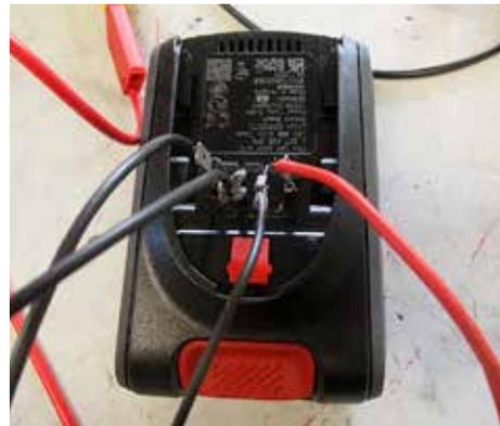
**MESSUNG:** Für eine kontrollierte Stromentnahme wurden die Akkus „angezapft“.
