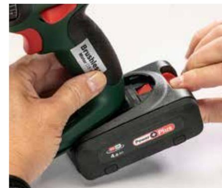
**UNPRAKTISCH:** Bei Bosch wird der Akku entgegen der Entriegelung entnommen.
