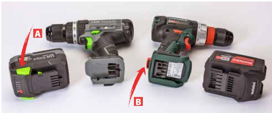
**VERBINDUNG:** Bei *Lux-Tools* **A** sitzt die Verriegelung am Akku, bei *Metabo* **B** wird der Werkzeugakku am Gerät selbst gelöst (Pfeile). Auffällig sind unterschiedlich viele elektrische Verbindungen.
