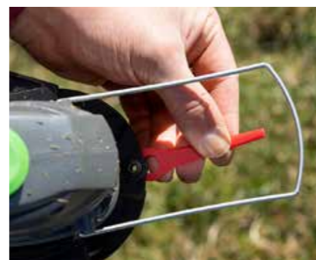
- ABSTAND: Bei Lux ist mit dem Schutzbügel kein randnahe Mähen möglich.
