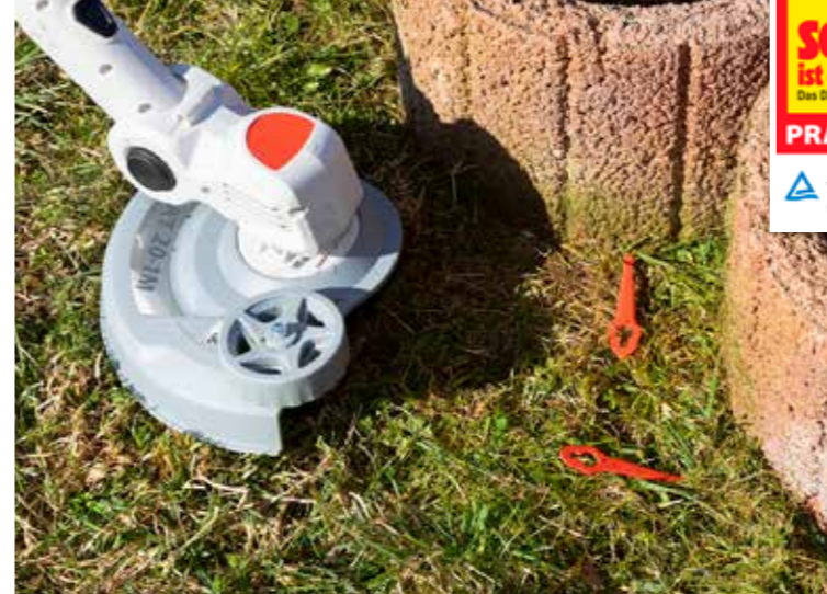
- VERLOREN: Die Geräte von Ikra und Hurricane können ihre Kunststoff-Messer an festen Hindernissen verlieren.
