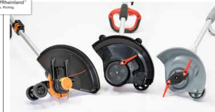
WERKZEUGE: Die getesteten Trimmer arbeiten mit Mähfäden aus einer Spule oder einem oder zwei wechselbaren Kunststoffmessern.
